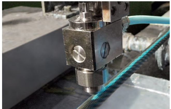
Znakowanie prętów stalowych
